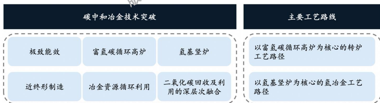
(图：宝武碳中和冶金技术路线图的主要技术突破及工艺路线)
